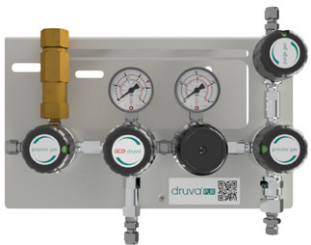
Typ MPLHOXDP5U Option PS HD Spülventil ND Absperrventil (Prozessgasspülung im Eingang | Absperrventil im Ausgang) Zusatz U Rückschlagsventil im Eingang Sicherheitsventil im Ausgang
