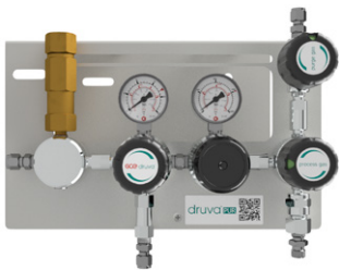
Typ MPLHOXDP0U Option P0 HD Spülventil (Prozessgasspülung im Eingang | keine Armatur im Ausgang) Zusatz U Rückschlagsventil im Eingang Sicherheitsventil im Ausgang
